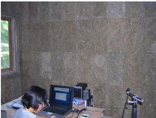
Gambar 5. Ruang yang telah dilapis panel jerami tengah diuji RT_{60} -nya
