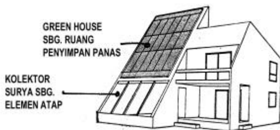
Gambar 8. Skema Integrasi Sistim Surya Pada Bangunan
