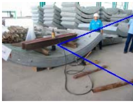
Figure 14. Tensile (Pull-out) Test set-up
